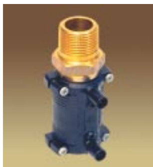
Переход полиэтилен – сталь с наружной резьбой* ПЭ 100 SDR 11, нерж., 16 бар
