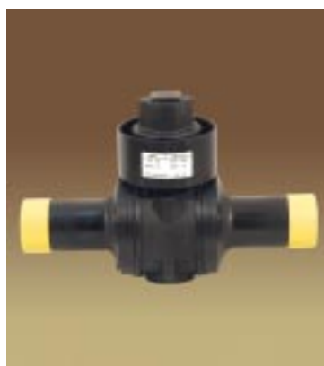
Шаровые краны из полиэтилена (изготавливаются из ПЭ 100, рабочее давление 16 бар) \varnothing 25*, 32, 40*, 50*, 63, 75*, 90, 110 мм
